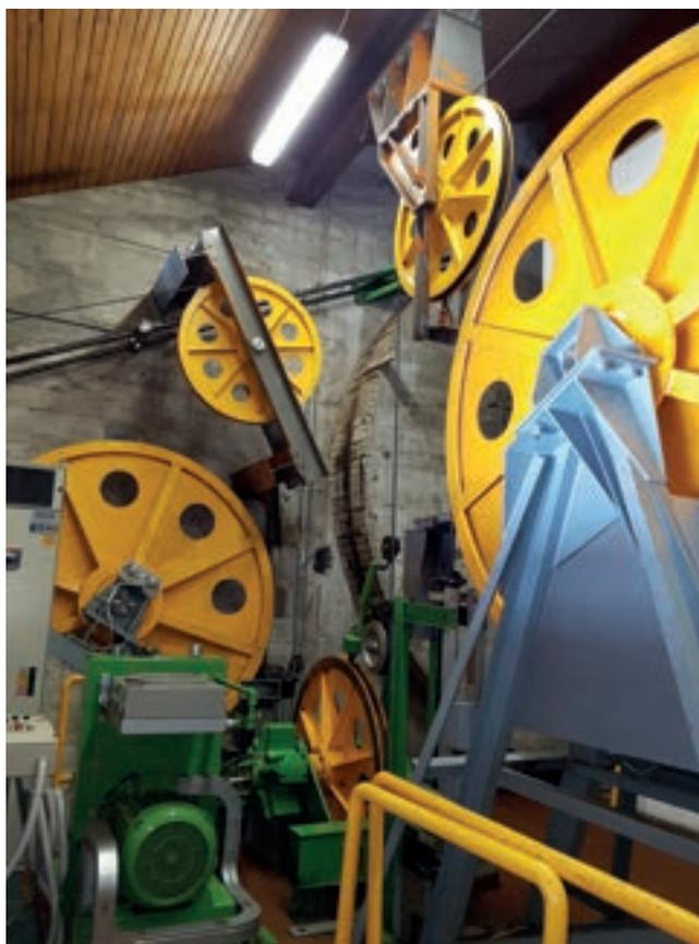
▲ L'interno della sala macchine. In primo piano si riconoscono i cinematismi di azionamento della traente, mentre in fondo c'è il tamburo di fissaggio delle portanti
